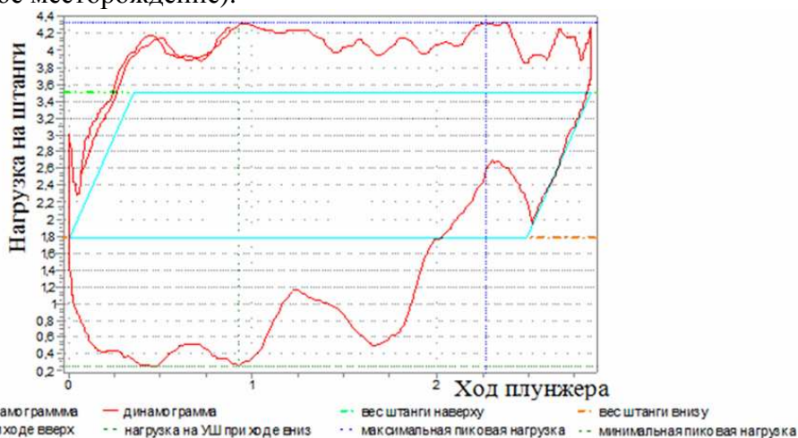
Рис. 2. Динамограммы скв. №3599 Ельниковского месторождения: а) до применения магнитного индуктора муфтового типа
