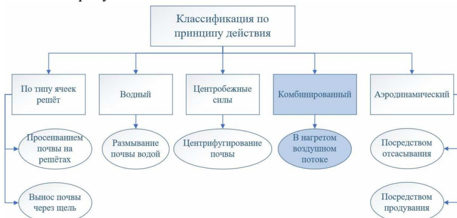
Рис. 1. Классификация рабочих органов для отделения почвы от клубней картофеля по принципу их воздействия
