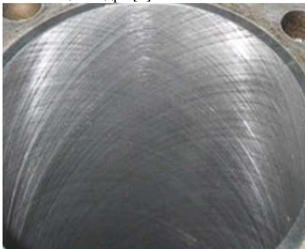
Рис. 1. Сетка, образованная микро-царапинами на рабочей поверхности гильзы
