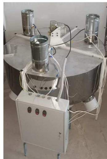
Рис. 1. СВЧ-размораживатель с состыкованными коаксиальным и коническим резонаторами
