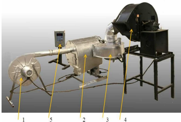
Рис. 1. Экспериментальная установка для предреализационной подготовки корнеклубнеплодов (картофеля) комбинированным способом: 1 – насос-вентилятор; 2 – камера с барабаном; 3 – сепаратор (водяной фильтр); 4 – насос-вентилятор; 5 – регулятор частоты вращения барабана
