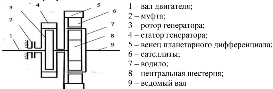
Рис. 1. Схема трансмиссии для лектротранспорта
