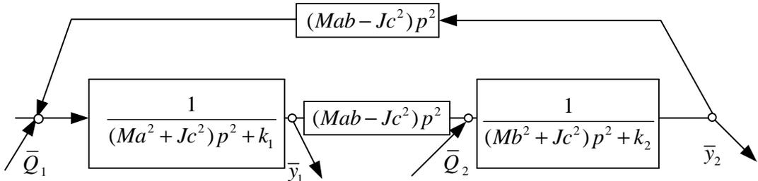
Рис. 2. Структурная схема механической колебательной системы (рис. 1),  $p = j\omega$  – комплексная переменная,  $j = \sqrt{-1}$ ,  $\omega$  – частота внешнего возмущения, символ «-» над переменной обозначает изображение Лапласа [5]
