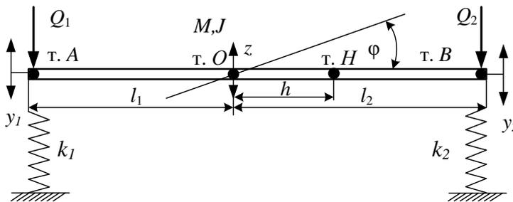
Рис. 1. Механическая колебательная система
