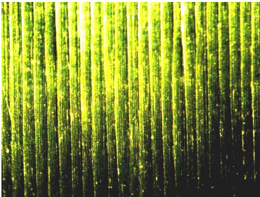
Рис. 2. Фото под микроскопом поверхности образца, обработанного точением без колебаний
