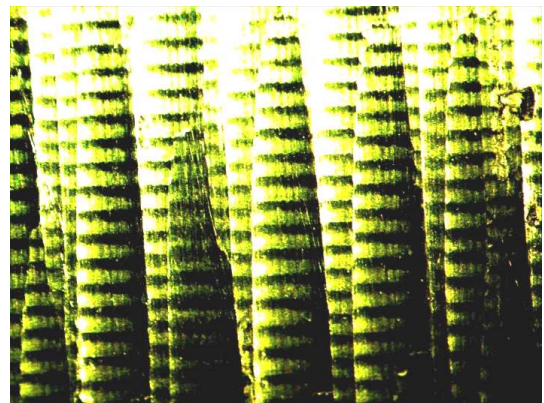
Рис. 5. Фото под микроскопом поверхности образца, обработанного вибрационным точением с частотой колебаний f = 23,9 Гц, амплитудой колебаний A = 10 мкм
