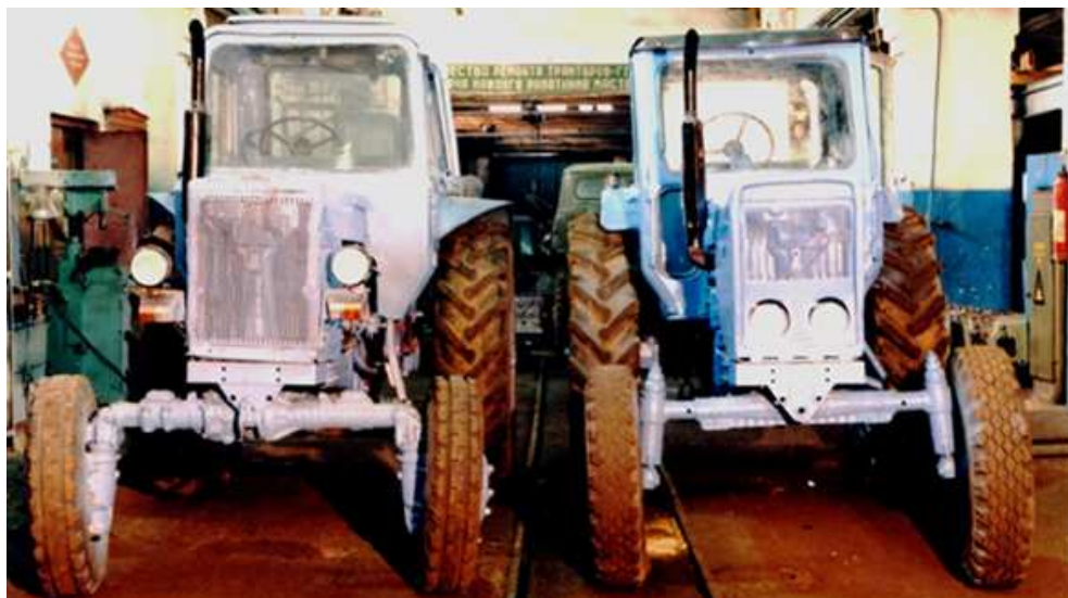
Фото 1. Отремонтированный трактор МТЗ-50 (справа), модернизированный от трактора МТЗ-52 в МТЗ-82 (слева), вид спереди
