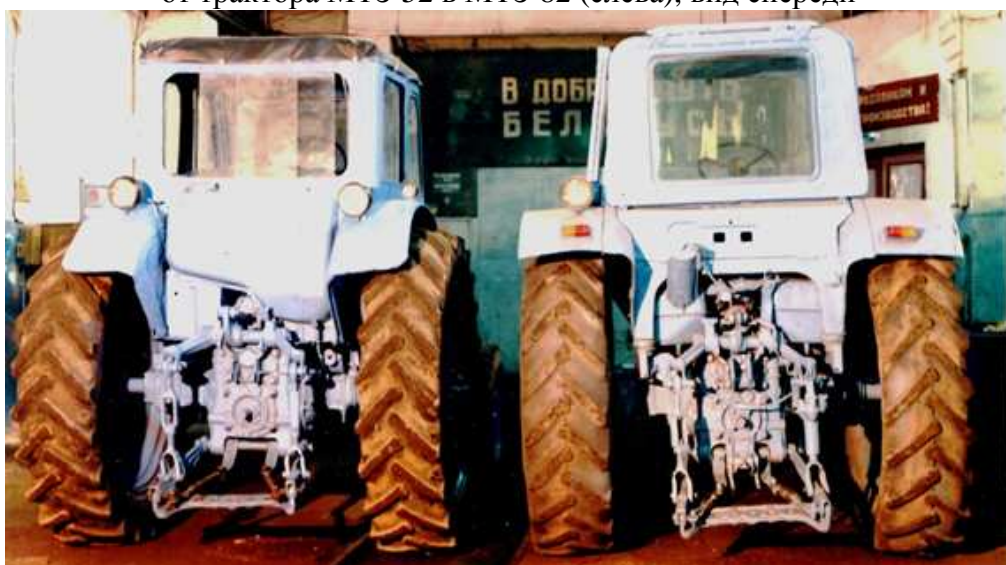
Фото 2. Отремонтированный трактор МТЗ-50 (слева), модернизированный от трактора МТЗ-52 в МТЗ-82 (справа), вид сзади
