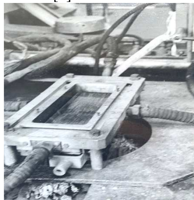
Рис.3. Внешний вид электромагнитного кристаллизатора для литья слитка 180x510 мм
