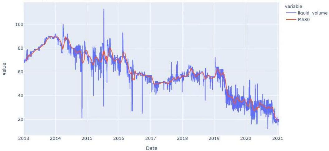
Рис. 2. Ежедневная добыча ( \text{м}^3 ) жидкости (liquid_volume) и фильтр скользящего среднего с длиной окна анализа в один месяц (MA30)
