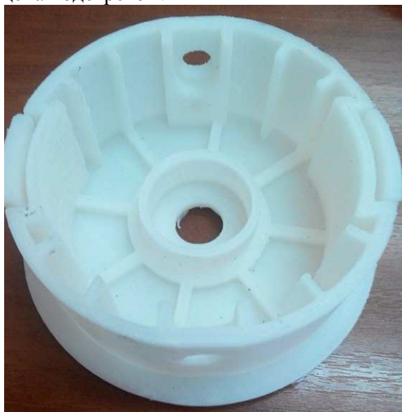
Рис. 1. Корпус, выполненный с помощью 3d-печати (материал - ABS-пластик)
