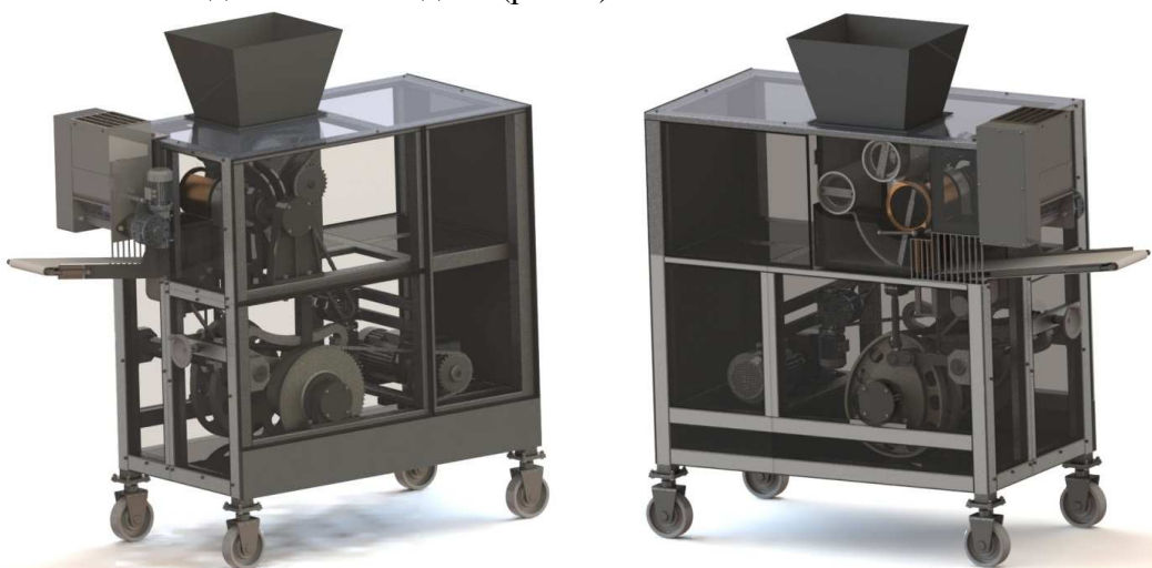
Рис. 1. Твёрдотельная модель разработанной конструкции тестоделительной машины с лопастным нагнетателем
