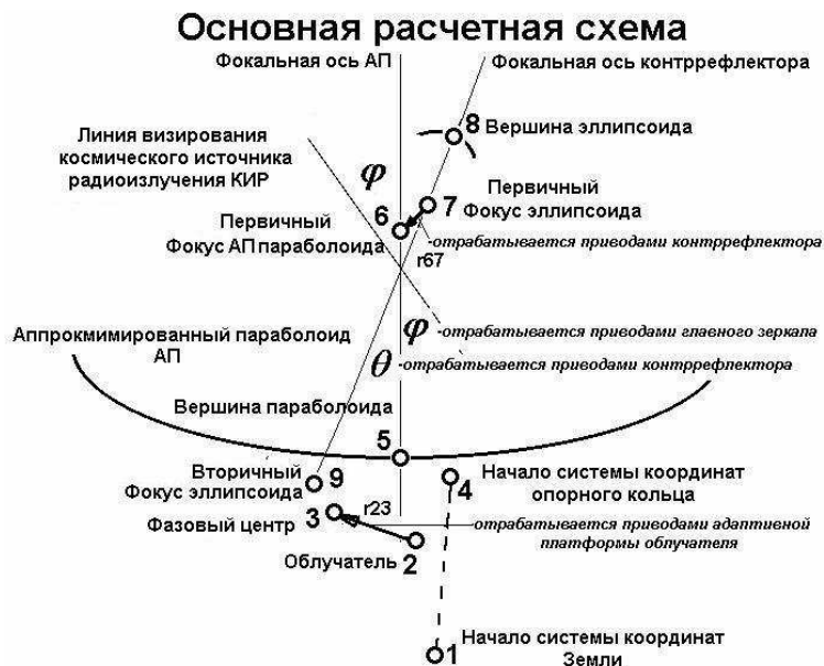
Рис.4. Основная расчетная схема системы наведения РТ
