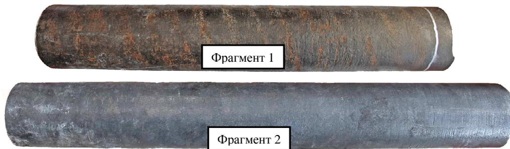
Рис. 1. Вид аварийной насосно-компрессорной трубы
