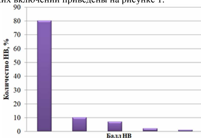
Рис. 1. Процентное содержание неметаллических включений в прокатном листе из стали 11ЮА, распределенное по баллам
