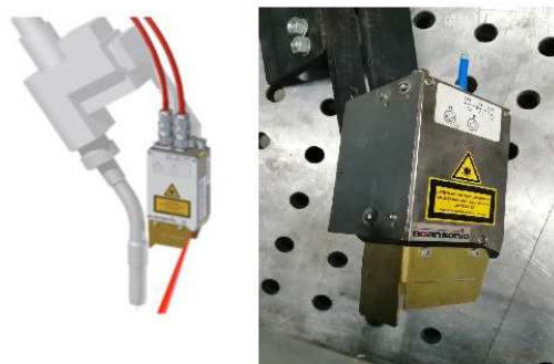
Рис. 5. Способ крепления и общий вид датчика TH6D
