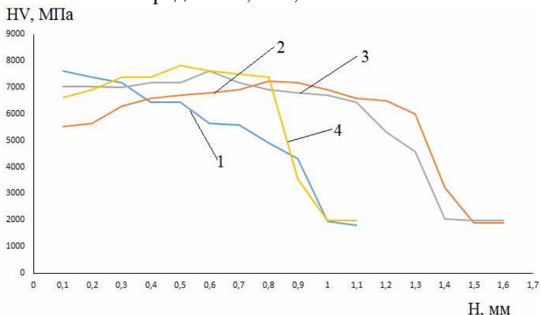
Рис. 2. Зависимость микротвердости стали 40Х от глубины слоя и режима обработки
