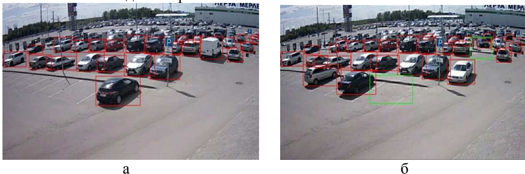
Рис. 2. Пример работы системы при автоматическом выделении парковочных мест; (а) первый кадр; (б) последующий кадр, на котором два места оказались свободными
