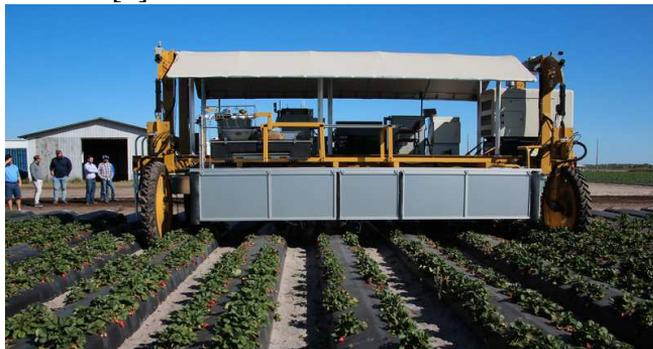
Рис. 6. Второй вариант опытного образца робота (Harvest CROO Robotics) на плантации
