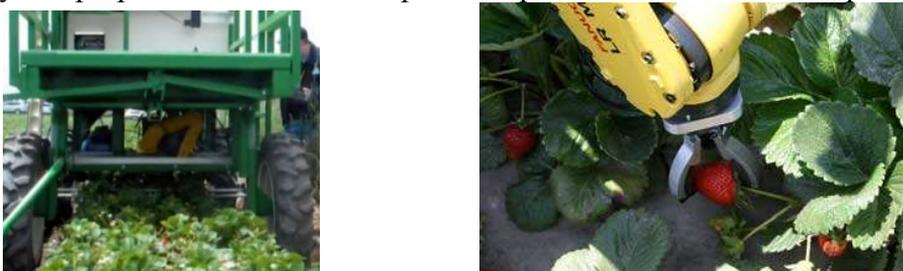
Рис. 2. Земляникоуборочный робот с манипулятором
