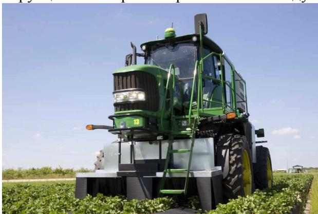
Рис. 5. Первый вариант прототипа робота в работе (Harvest CROO Robotics)
