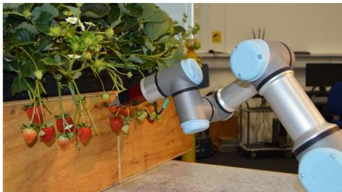
Рис. 8. Испытательный стенд для отработки алгоритмов съёма ягод
