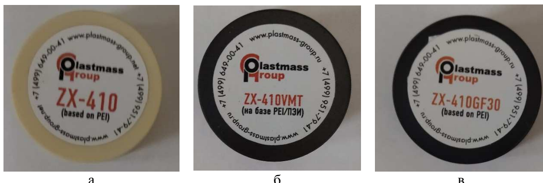
Рис. 1. Образцы полиэфиримида и композитов: а – ZX-410, б – ZX-410VMT, в – ZX-410 GF30
