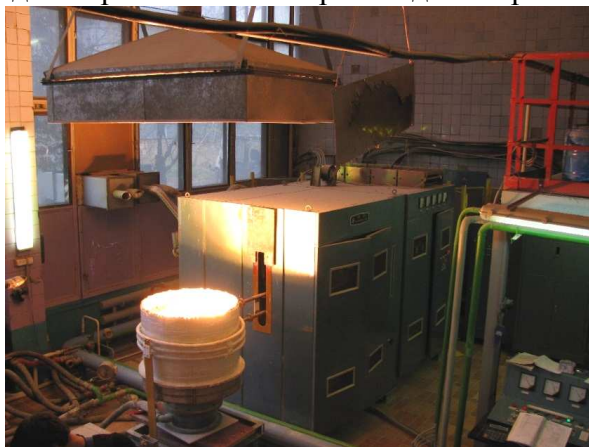
Рис.1. Установка большой мощности с диаметром тигля 700 мм в процессе синтеза ЧСЦ кристаллов
