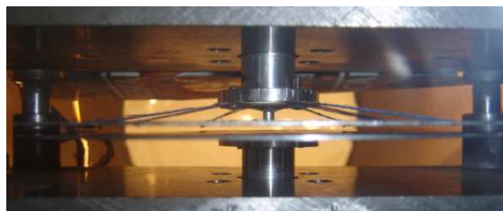
Рис. 2. Подвеска верхнего "ведомого" диска на нитях
