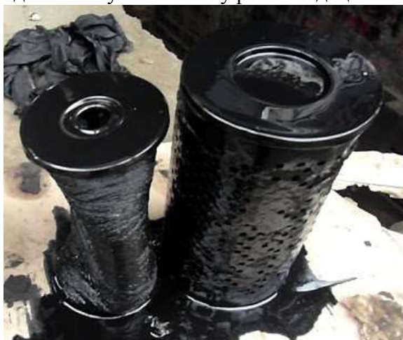
Рис. 6. Внешний вид масляных фильтроэлементов дизелей при смешивании моторных масел SAE 5W-40 и M8Г 2 К
