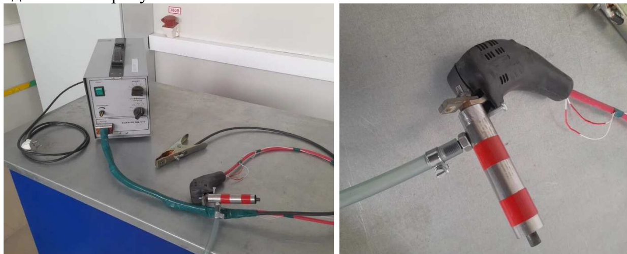
Рис. 1. Установка для электроэрозионного нанесения металлических покрытий Alier-Metal G53
