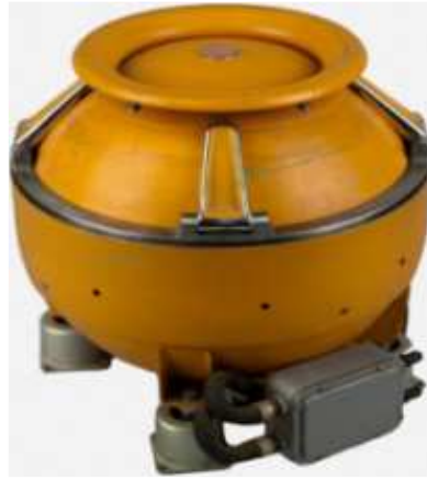
Рис. 3. Защищённый накопитель системы K9-51
