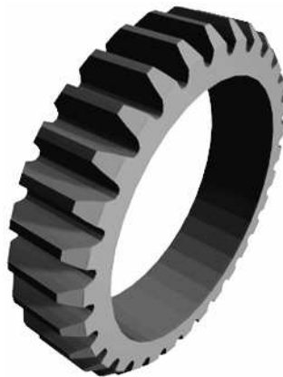
Рис. 3. 3D-модель для изготовления инструмента «зубчатый притир» с помощью аддитивной технологии.
