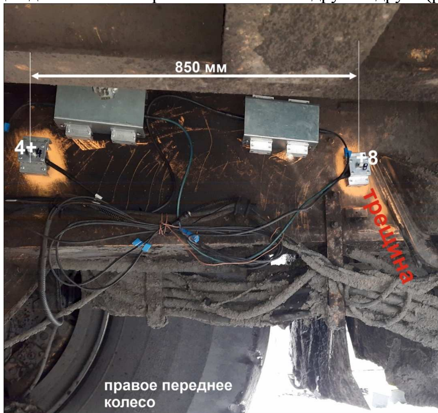
Рис. 1. Схема установки датчиков АЭ
