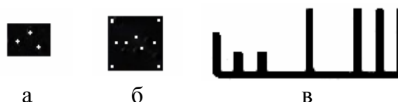
Рис. 7. Изображения шаблонов: а – объект прямоугольной формы (32x24 мм), б – объект квадратной формы (40x40 мм); в – объект сложной формы
