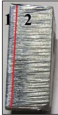
Рис. 1. Поверхность реза с характерными зонами: 1) зона плавления металла; 2) зона удаления расплава газом
