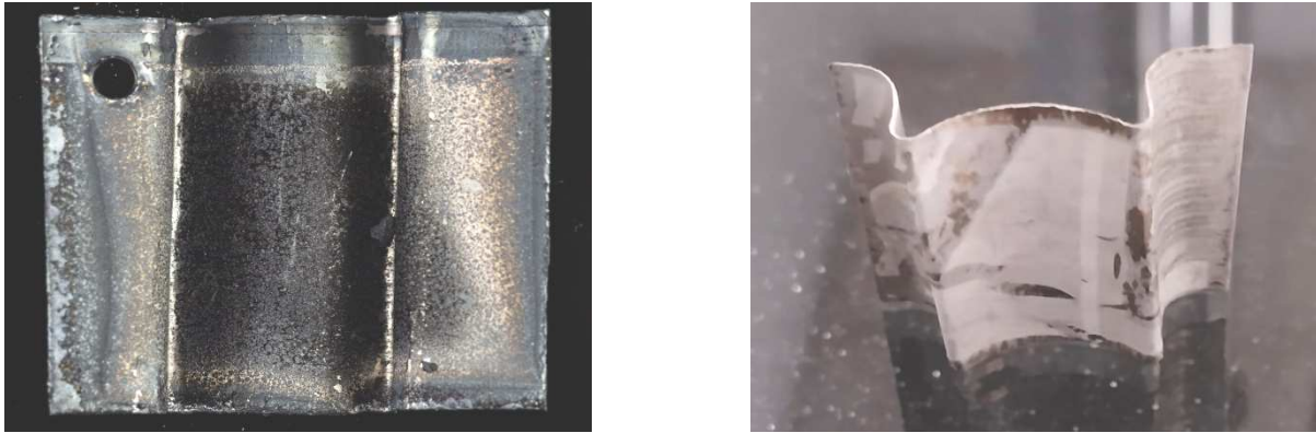
Рис. 7. Деформированная заготовка по результатам натурального эксперимента
