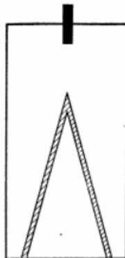
Рис. 2. Схема кумулятивного заряда
