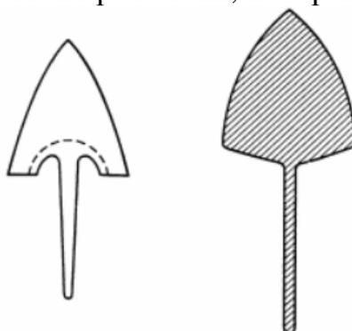
Рис. 3. Схематичное изображение кумулятивной струи
