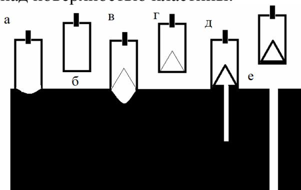
Рис. 1. Схематичное изображение результатов воздействия на поверхность различной компоновки заряда
