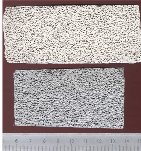
Рис. 2. Образцы пористых материалов: автоклавный и неавтоклавный газобетон
