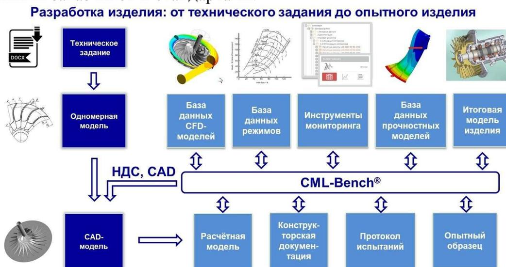
Рис. 1. Процесс создания цифрового двойника в системе CML-Bench [3]
