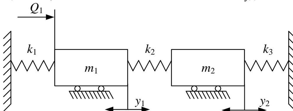
Рис. 1. Расчётная схема в виде механической колебательной системы с сосредоточенными параметрами
