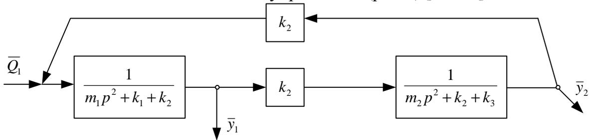
Рис. 2. Структурная схема механической колебательной системы на рисунке 1
