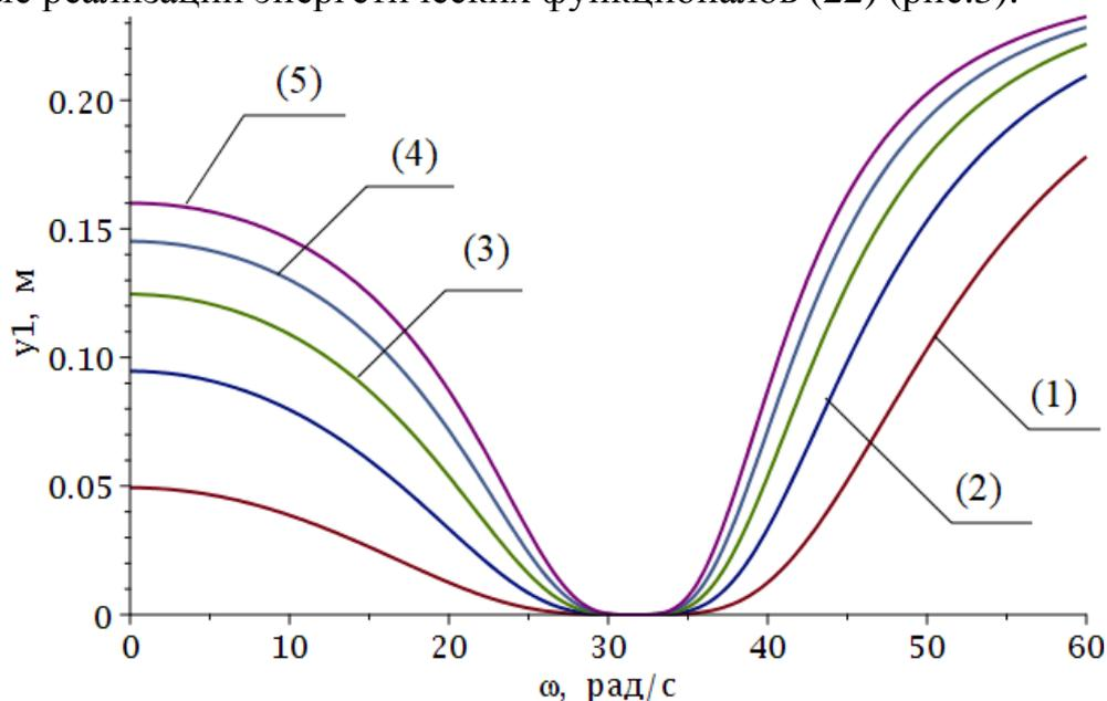
Рис. 3. Определение частоты динамического гашения.
