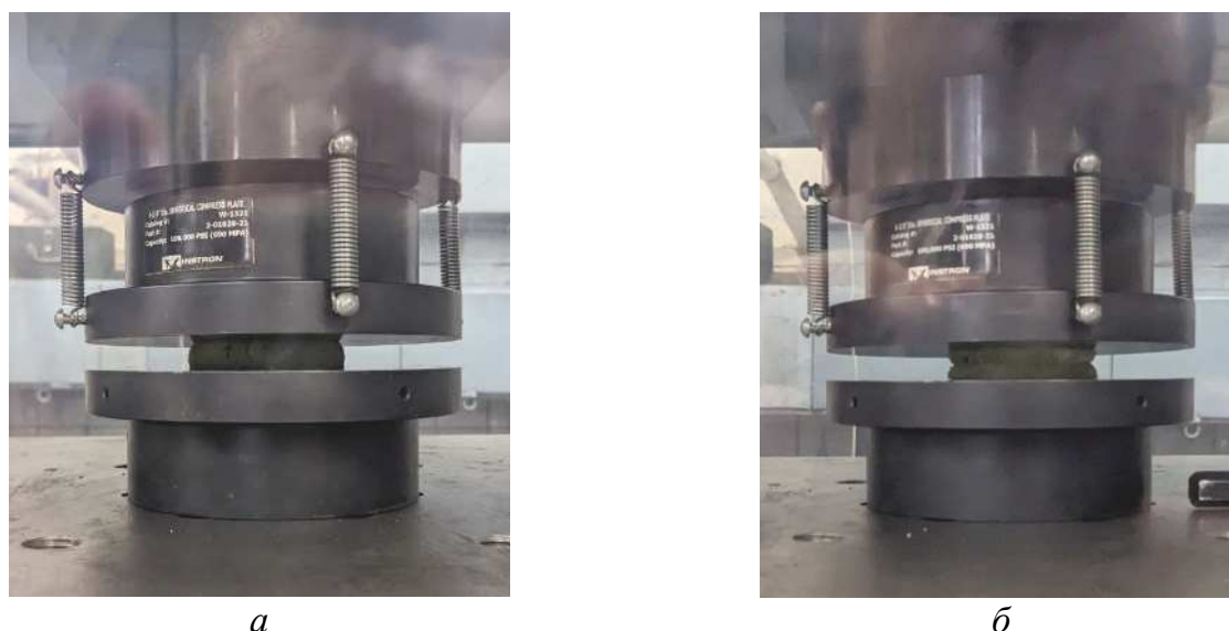
Рис. 2. Образцы на испытательной машине во время деформирования: а – образец из «СКУ-ПФЛ-100»; б – образец из композитного материала
