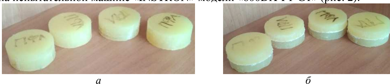
Рис. 1. Образцы: а – из «СКУ-ПФЛ-100»; б – из композитного материала
