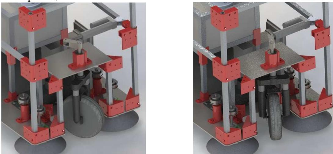
Рис. 4. Поворотный механизм робота уборщика
