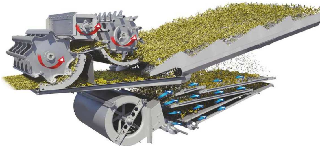
Рис. 1. Общий вид принципа работы битера
