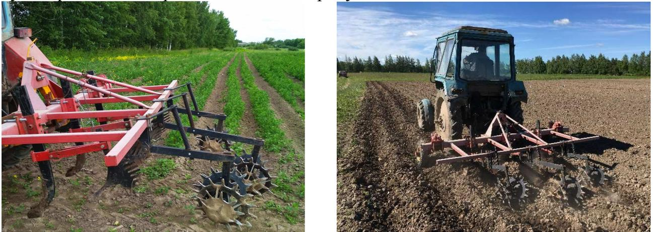
Рис. 1. Многоцелевой пропашной культиватор – глубокорыхлитель
