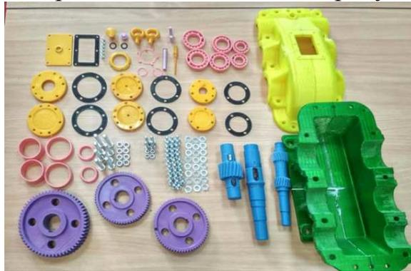
Рис. 5. Детали для сборки редуктора
