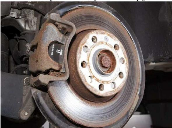
Рис. 7. Наличие сильной коррозии в местах соприкосновения колодки и диска
