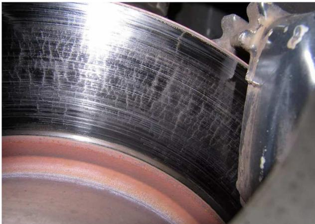
Рис. 3. Наличие на тормозном диске микротрещин
