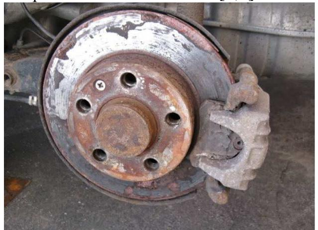
Рис. 6. Ржавление тормозного диска
