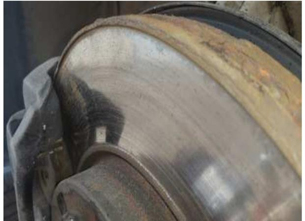
Рис. 4. Износ тормозного диска
