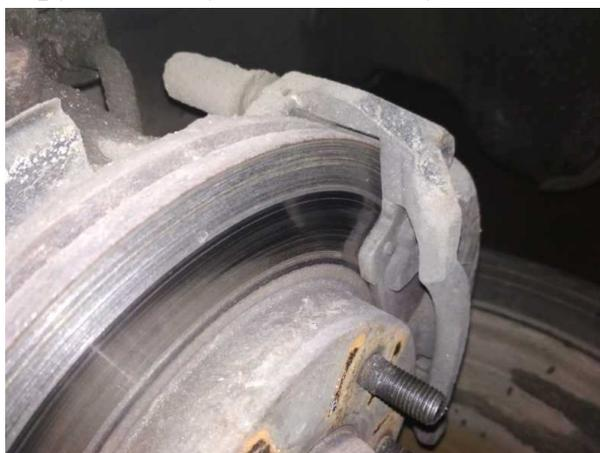
Рис. 5. Наличие на тормозном диске микротрещин
