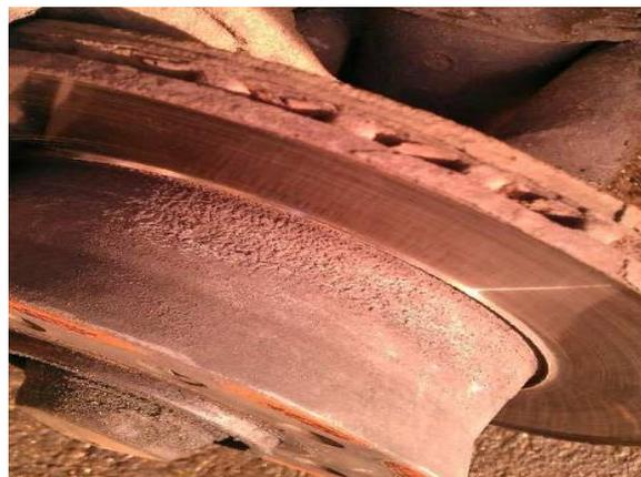
Рис. 8. Наличие сильной коррозии на поверхностях вентиляционных каналов
