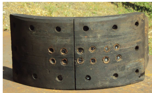
Рис. 5. Колодка, с встроенным устройством для снижения тепловой нагруженности
