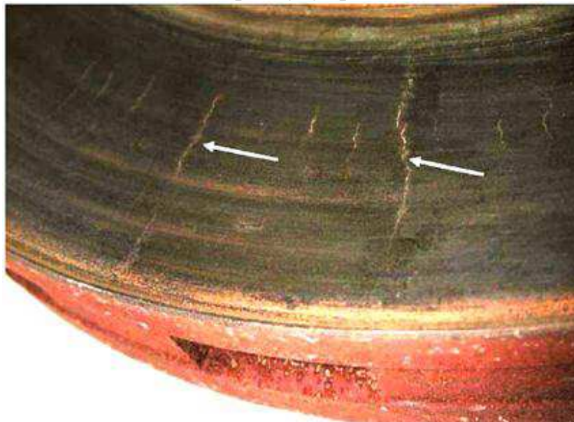
Рис. 4. Термическое растрескивание в дисковых тормозах
