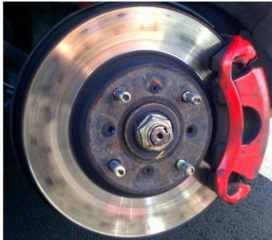
Рис. 3. Образование горячих точек на тормозном диске
