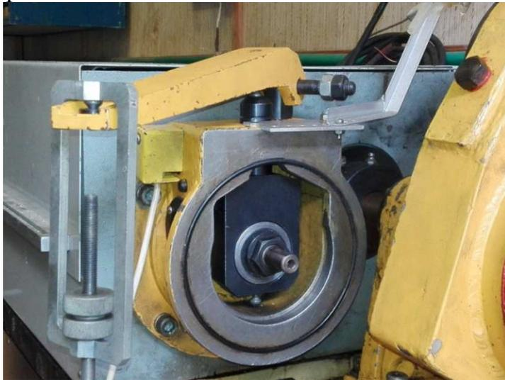
Рис. 1. Узел машины трения ИИ-5018 с установленными образцами
