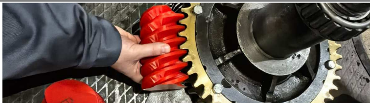
Рис. 4. Процесс оценки совпадения осевого шага
