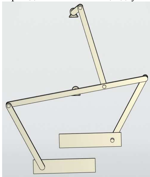
Рис. 4. Схематичная трехмерная модель ножниц с параллельными ножницами
