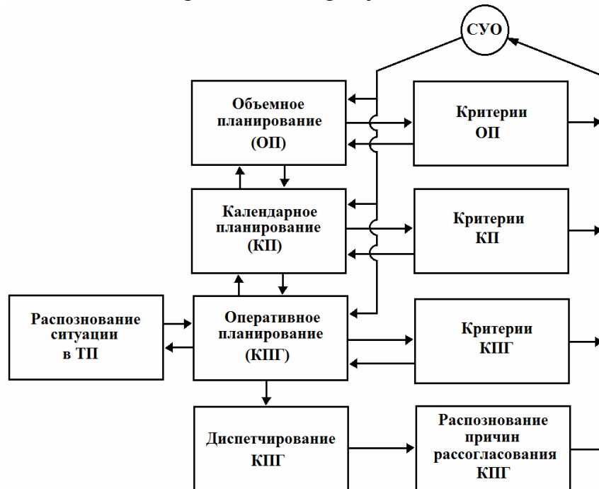
Рис. 1. Схема работы АСУТП
