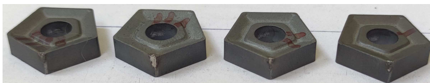
Рис. 2. Фото пластин Т5К10 после фрезерования 9 мм
