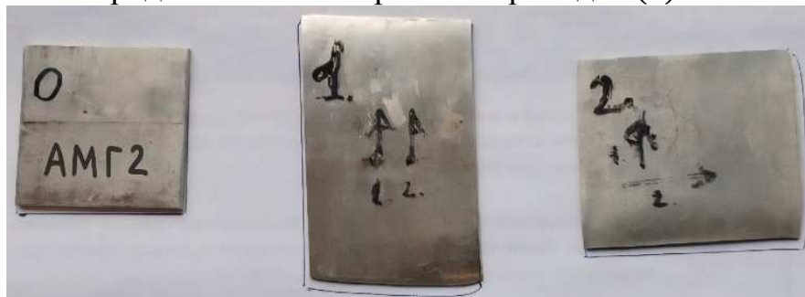
Рис. 1. Алюминиевые листы АМг2 до прокатки (0) и после двух продольных (1) и второго поперечного прохода (2) на двухвалковом стане
