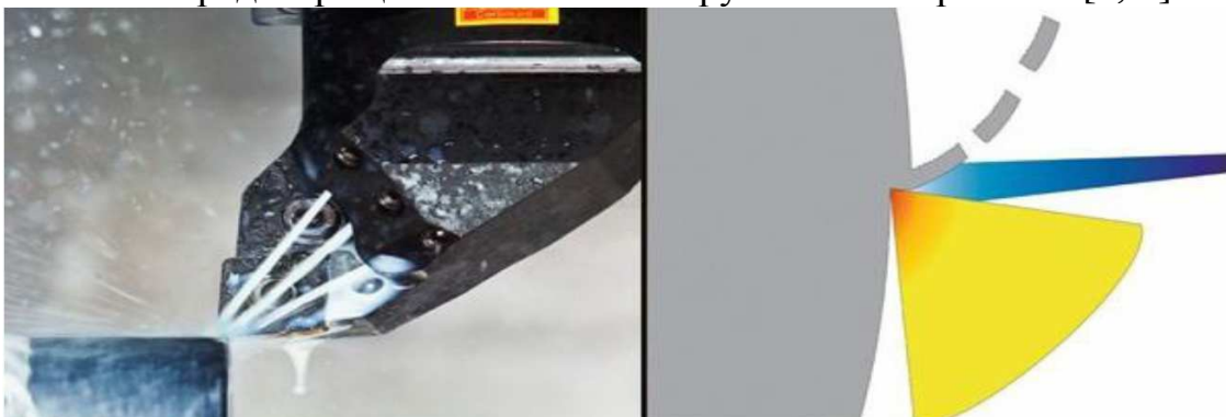
Рис. 1. Охлаждение под высоким давлением [4]
